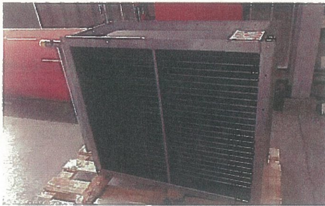
Figura 16 Um dos permutadores de calor instalados nos túneis de compostagem da CDA
